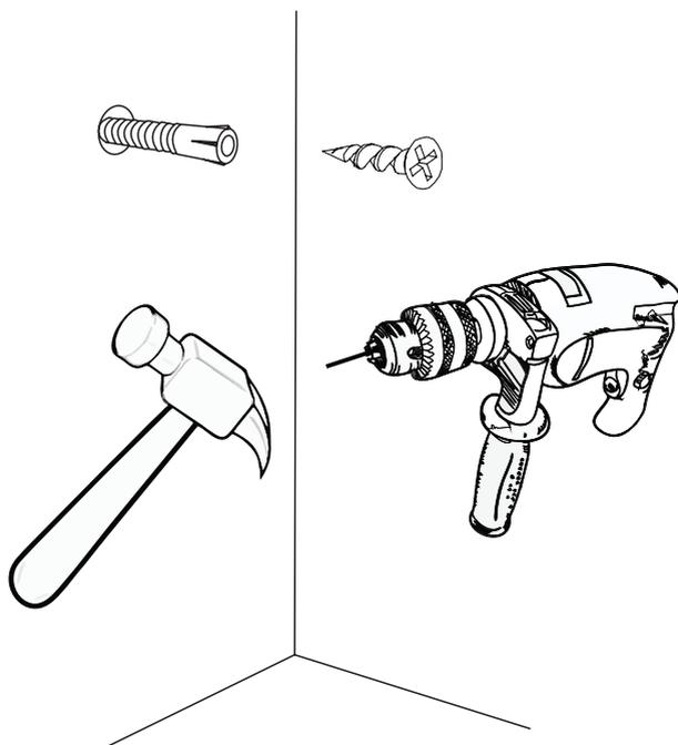
**ВНИМАНИЕ!** В комплектацию входит дюбель, предназначенный только для бетонной и кирпичной стен. Для гипсокартонной стены дюбеля подобрать самостоятельно, а так же заложить усиленный каркас для правильного распределения нагрузки изделия.
